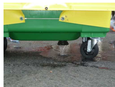
Bouchon au fond d'un bac roulant qui permet d'évacuer les liquides des bouteilles
